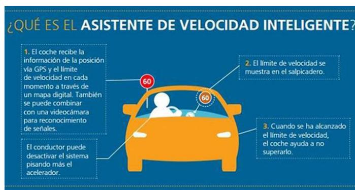
Este sistema, formado por el navegador del vehículo, que muestra el límite de velocidad en la vía por la que se circula, y un sistema de reconocimiento de señales que complementa a la cartografía digital y detecta limitaciones temporales de velocidad, ayuda al conductor a conocer y respetar los límites de velocidad, contribuyendo de este modo a la mejora de la seguridad vial.
